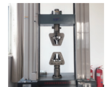
拉伸试验装置
